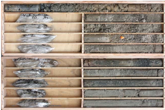
図-5 ボーリングコア(25mのうち上部10m)
